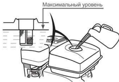
Рис. 7 Максимальный уровень топлива в топливном баке
