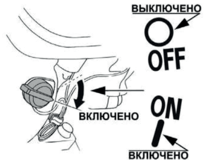
Рис. 11. Выключатель зажигания в положении «Включено»
