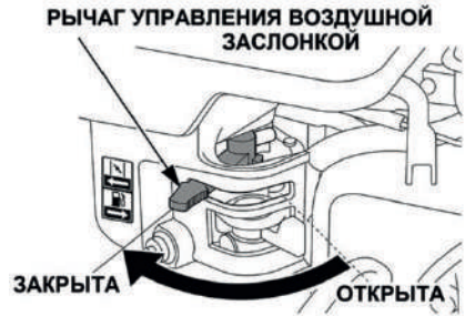
Рис. 9. Воздушная заслонка закрыта
